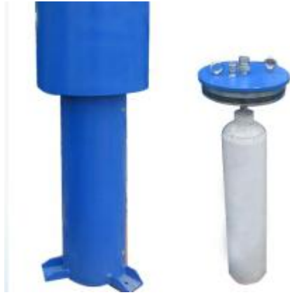
气瓶水压涨套式密封以及水套
